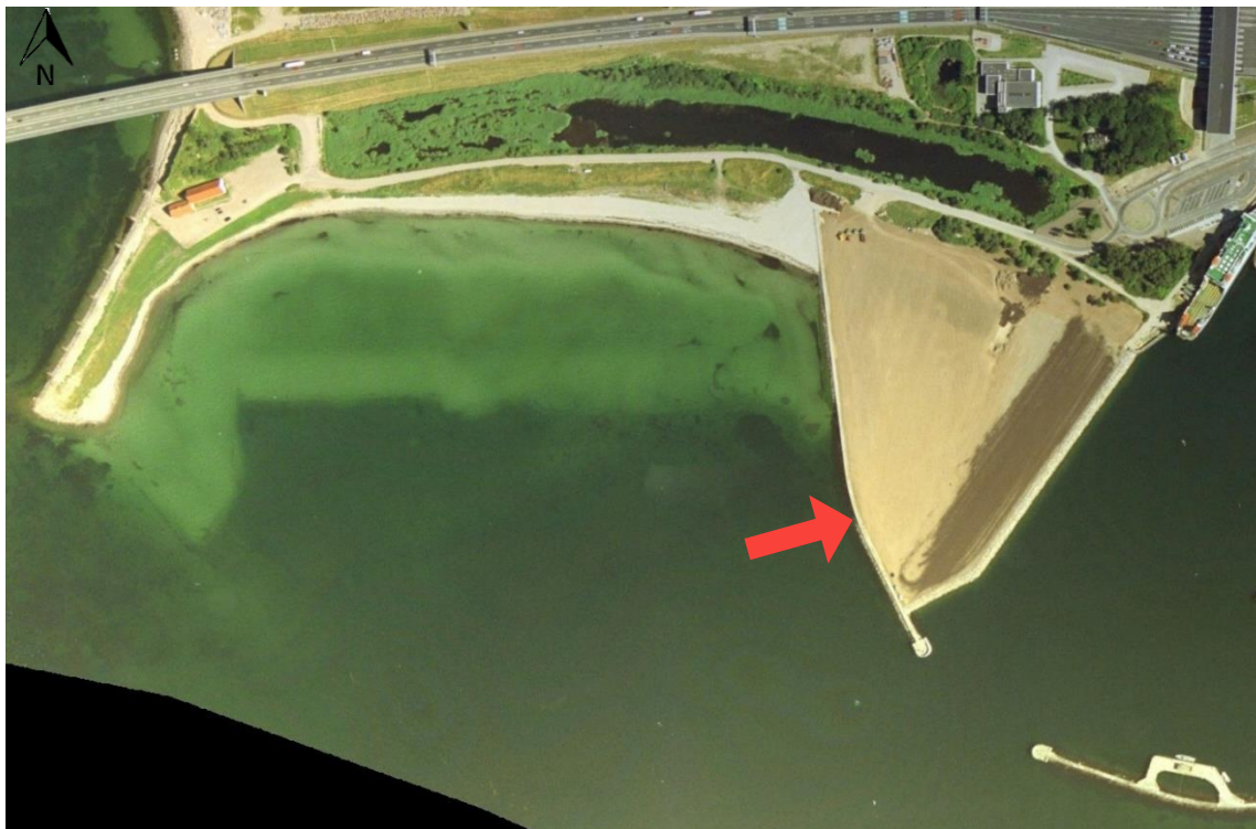
Figur 4: Luftfoto fra 1999, hvor området på bagsiden af molen er blevet fyldt op. Pil markerer molen.
