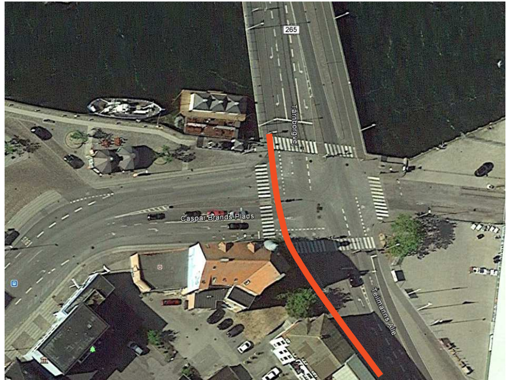
Figur 4-5 Sikring af Punkt A (se Figur 4-7), vejrydset ved Halskovbroen, Tårnbogvej/Casper Brands Plads. Sikringslinje markeret med orange (70 m).
