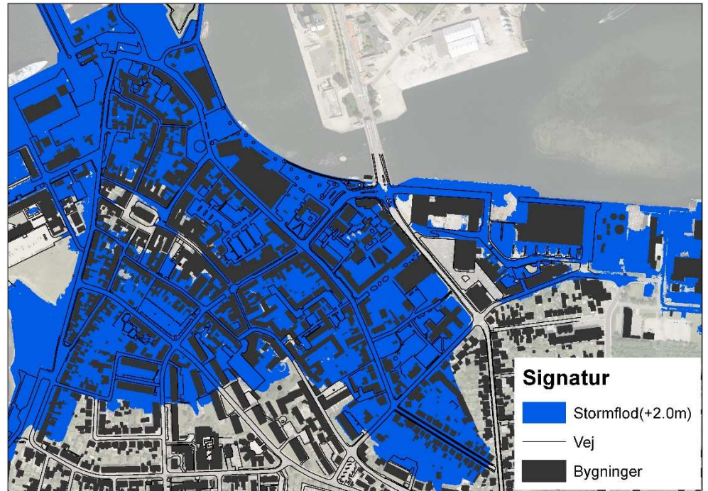
Figur 3-3 Oversvømmelsesudbredelse ved stormflod i kote +2,0 (100 års hændelse fremskrevet til 2050).
