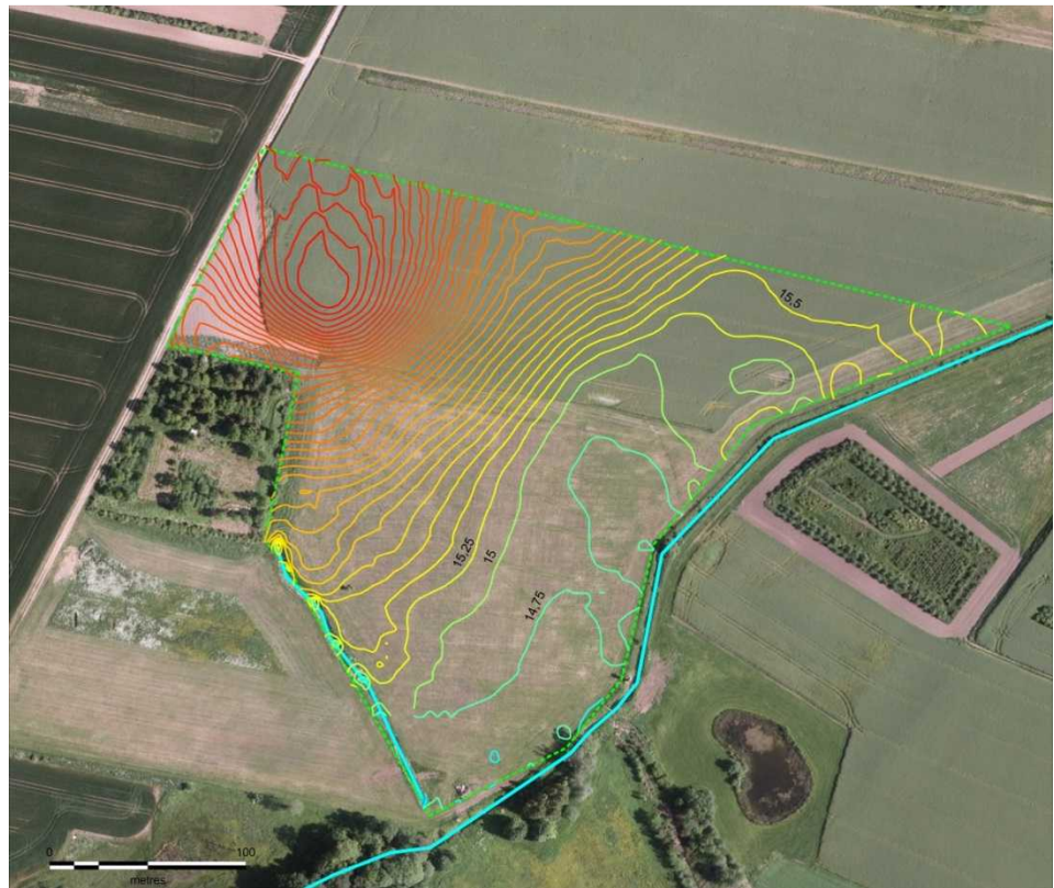
Figur 2-3 Konturkort med 0,25 m ækvidistance baseret på opmåling leveret af Slagelse Kommune.
