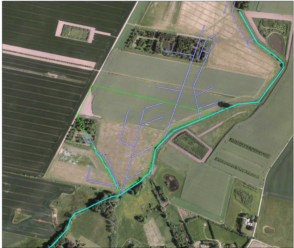
Figur 2-2 Drænkort som viser dræn (hvide/blå linjer) fra det direkte opland samt interne dræn i projektområdet (grøn stiptet linjeafgrænsning).
