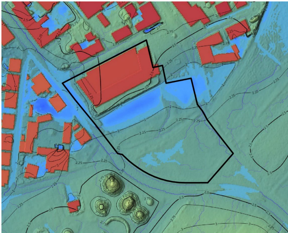
Figur 8.1 Oversvømmede områder ved 30 mm nedbør og strømningsveje ud af planområdet.
