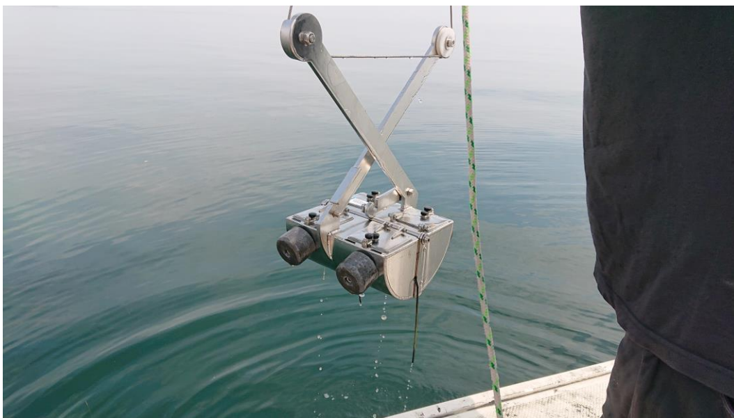
Figur 3-4 Mini vanWeen sedimentprøvetager anvendt til både sedimentkemiprøver, og bundfaunaprøver.
