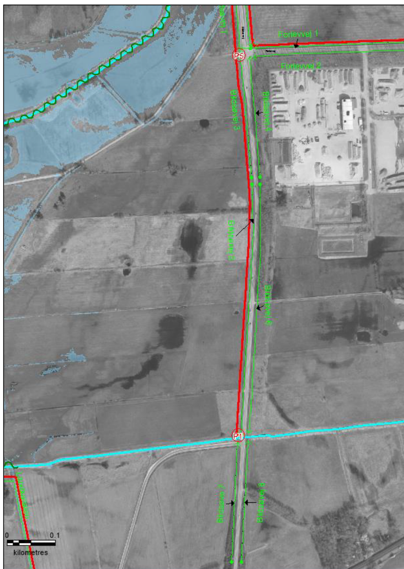
Figur 13: Afløb fra vejgrøfter til pumpestation P1. Fra Tude Ådal, Ansøgning efter vandløbsloven og kystbeskyttelsesloven af 28. april 2025, udarbejdet af NIRAS.
