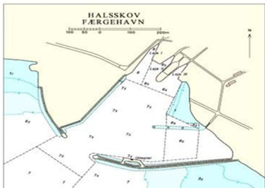
Figur 3-8: Dybdeforhold i havnen efter anlæg af oplæggerplads for færger. Kilde: Den Danske Havnelods – nu ikke længere tilgængelig for Halskov Havn
