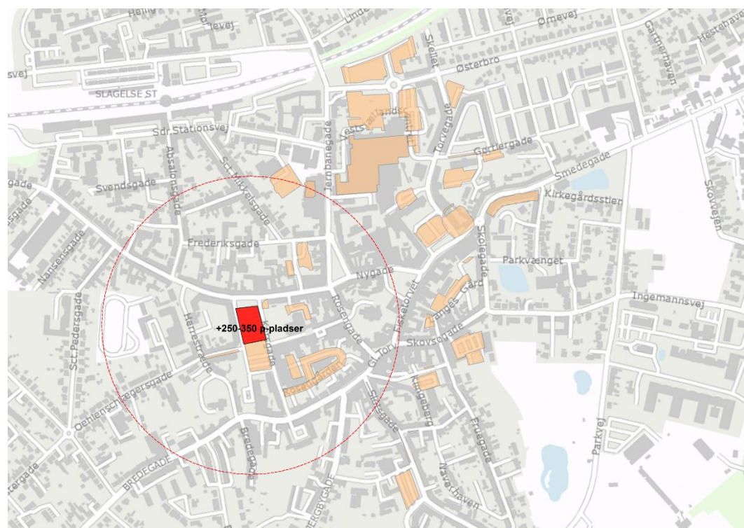
Figur 2. Forslag til parkeringshus på den nordlige del af H.P. Hansens Plads. Mulighed for at etablere 250-350 ekstra parkeringspladser ved en 3 eller 4 etagers konstruktion. Ringen markerer 300 m radius fra p-pladsen, svarende til en gangafstand på under 400 m.
