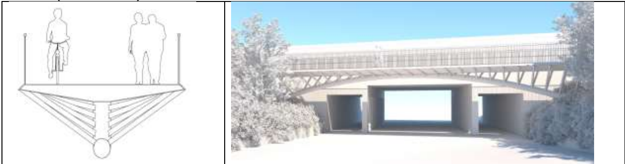
Figur 4. Til højre i figuren vises broens tværsnit. Til venstre i figuren ses broen fra Kalundborgvej.
