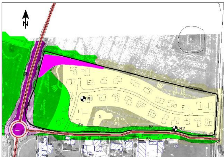
Støjmodel med evt. etablering af en støjvold (pink markering) i nordvestligt skel. Grøn markering viser en støjbelastning på 58-63 dB.
