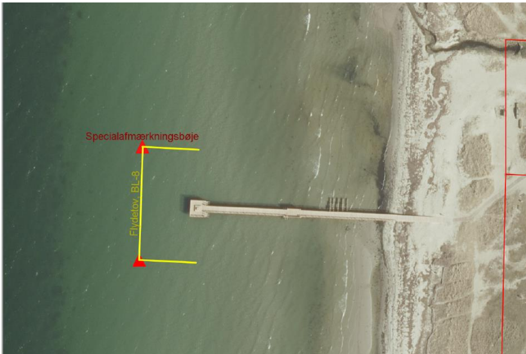
Figur 2: Markering af området hvor der ønskes udlagt et gul flydespærring/badezone, som endvidere er markeret med specialafmærkningsbøjer i hjørnerne. Badezonen skal hindre både og joller i at sejle ind til broen og de badende. Det er muligt at fjerne svømmezonen ved eksempelvis Harboe Cup, og den tages på land i vinterhalvåret.
