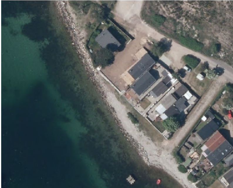
Billede 4: I 2012 er stranden forsvundet på en del af strækningen, bl.a. på grund af udlægning af sten og manglende vedligeholdelse med sand
