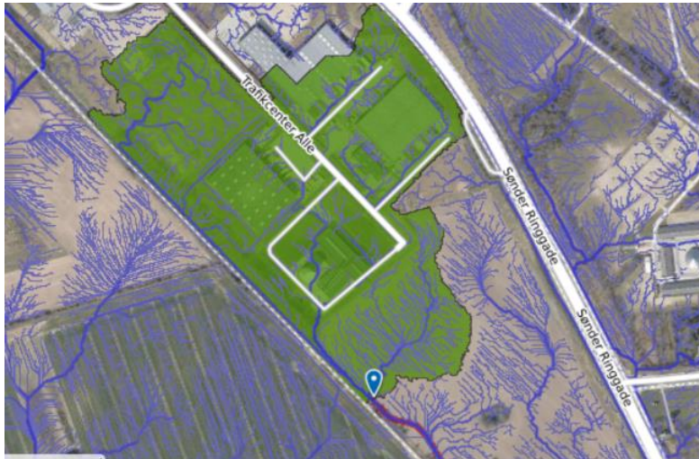
Grøft langs Fodsporet (se markering) der afvander et større område markeret med grøn på kortet.
