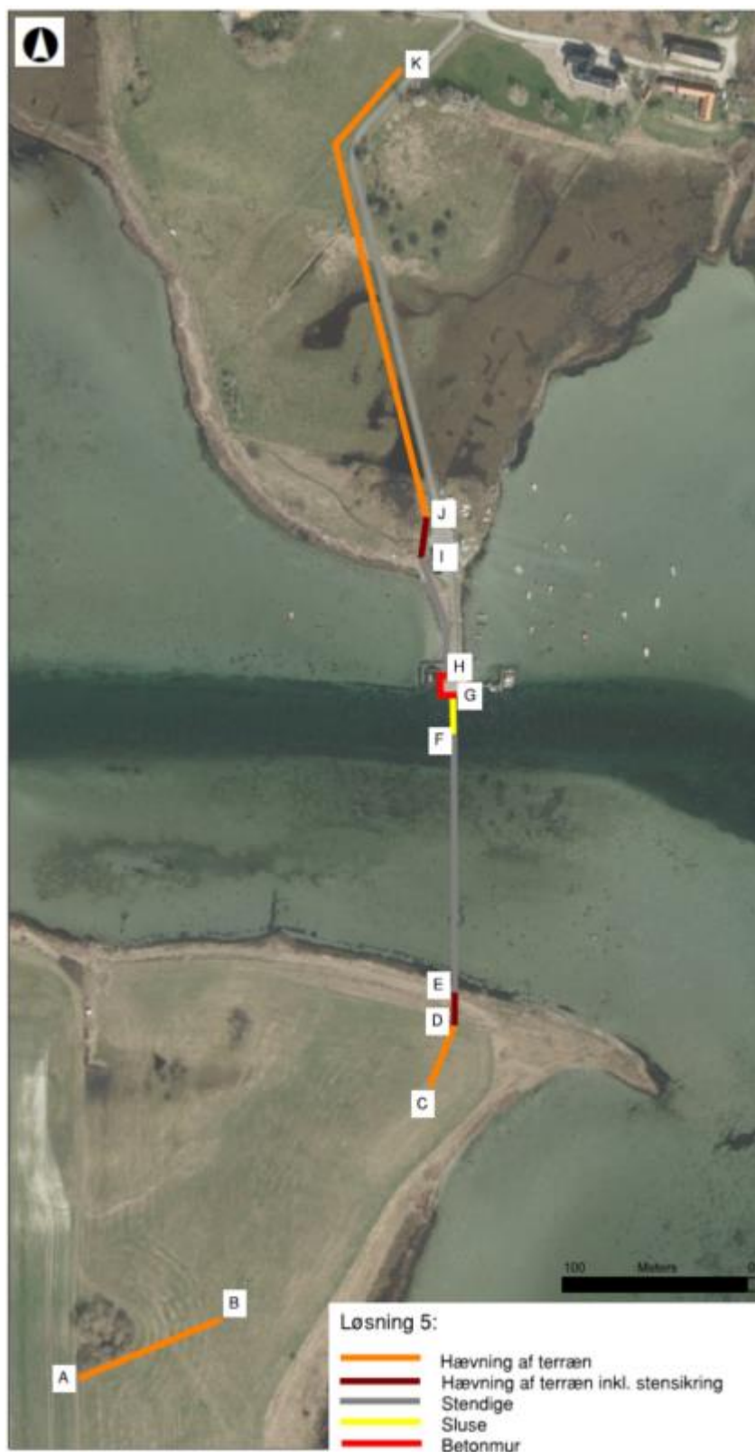
Figur 6-22 Princip for sikring af havnen – Løsning 5
