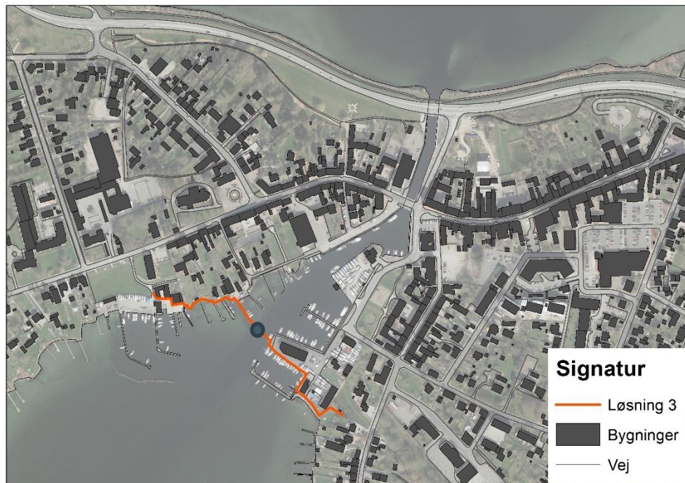
Figur 1-3 Principskitse for Løsning 3. Løsningen har få landbaserede sikringstiltag, men indeholder etableringen af en sluse/højvandsport i indløbet til havnen (markeret med prik).
