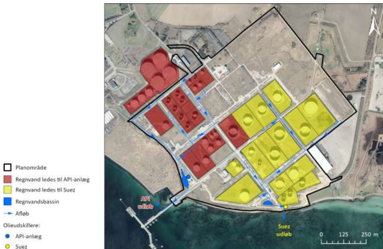
Figur 9-4 Regnvand fra tankgårde og -tage der føres til henholdsvis API-anlægget og Suez.
