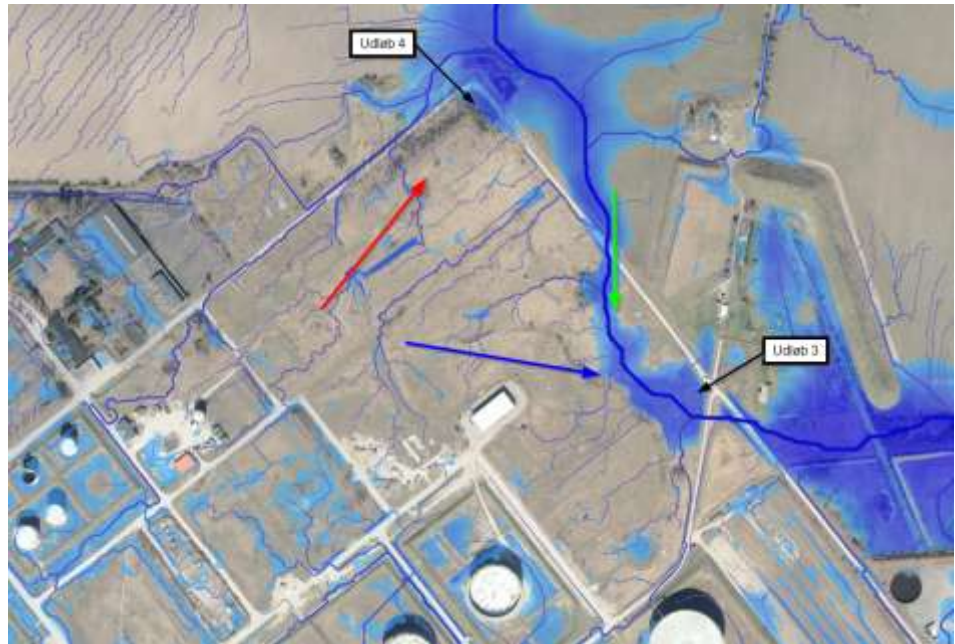
Figur 9-3 De nuværende strømningsveje for regnvand i den nordlige del af lokalplanområdet samt placeringen af de to udløb til Maderenden (Scalgo Live).
