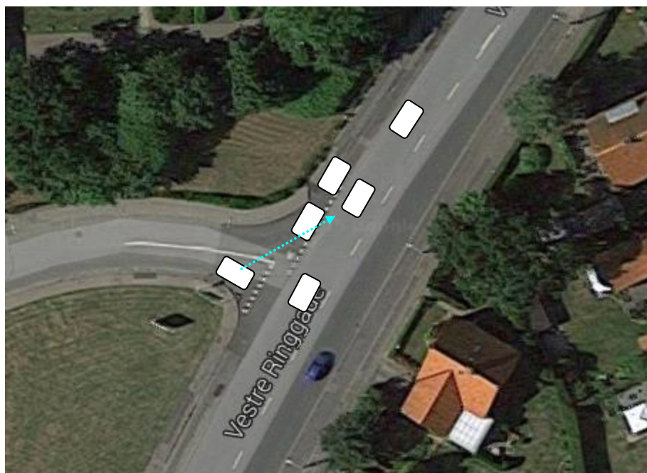
Figur 5 – Oversigtsproblem ved etablering af højresvingsbane
