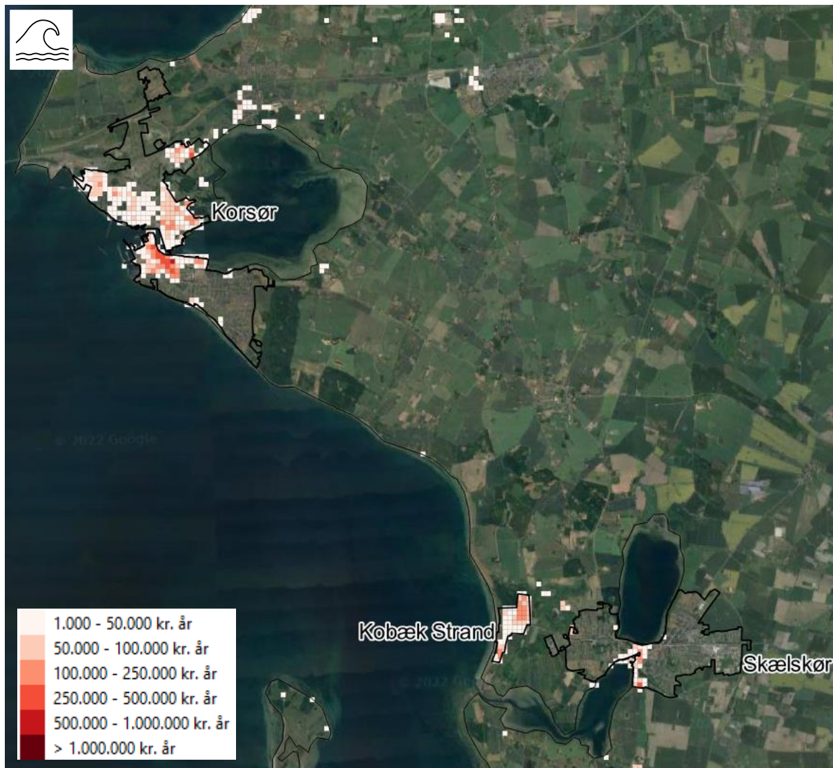
FIGUR 1-2: EKSEMPEL PÅ 100*100 M CELLER SOM ANVENDES TIL AT OPSUMMERE RESULTATERNE. EKSEMPELET VISER RISIKO FOR STORMFLOD.
