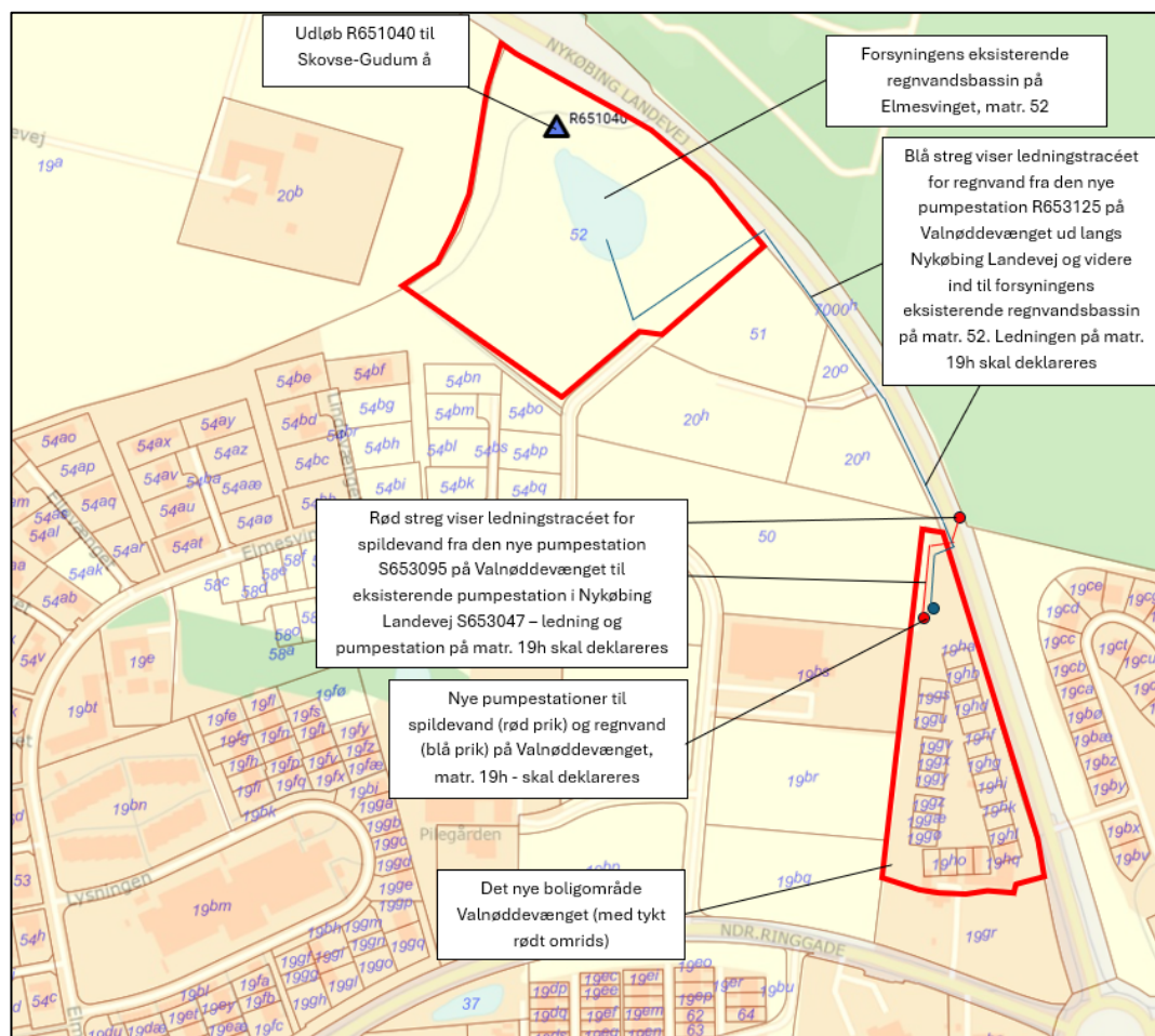
Figur 6: Området Valnøddevænget, forsyningens eksisterende regnvandsbassin, eksisterende udløb R651040 (rødt omruds), samt ledningstracé langs Nykøbing Landevej.
