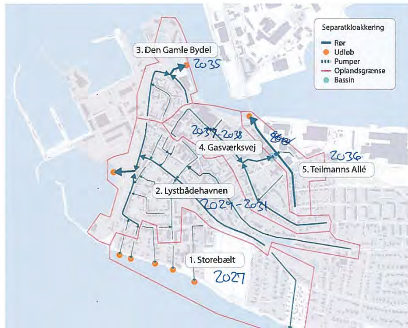
Figur 2 Plan for regnvandsafledning i Korsør (Basisscenario), indeholdende: Oplandsafgrænsning, ledningsnet, bassiner aflastningspunkter og pumpestationer.
