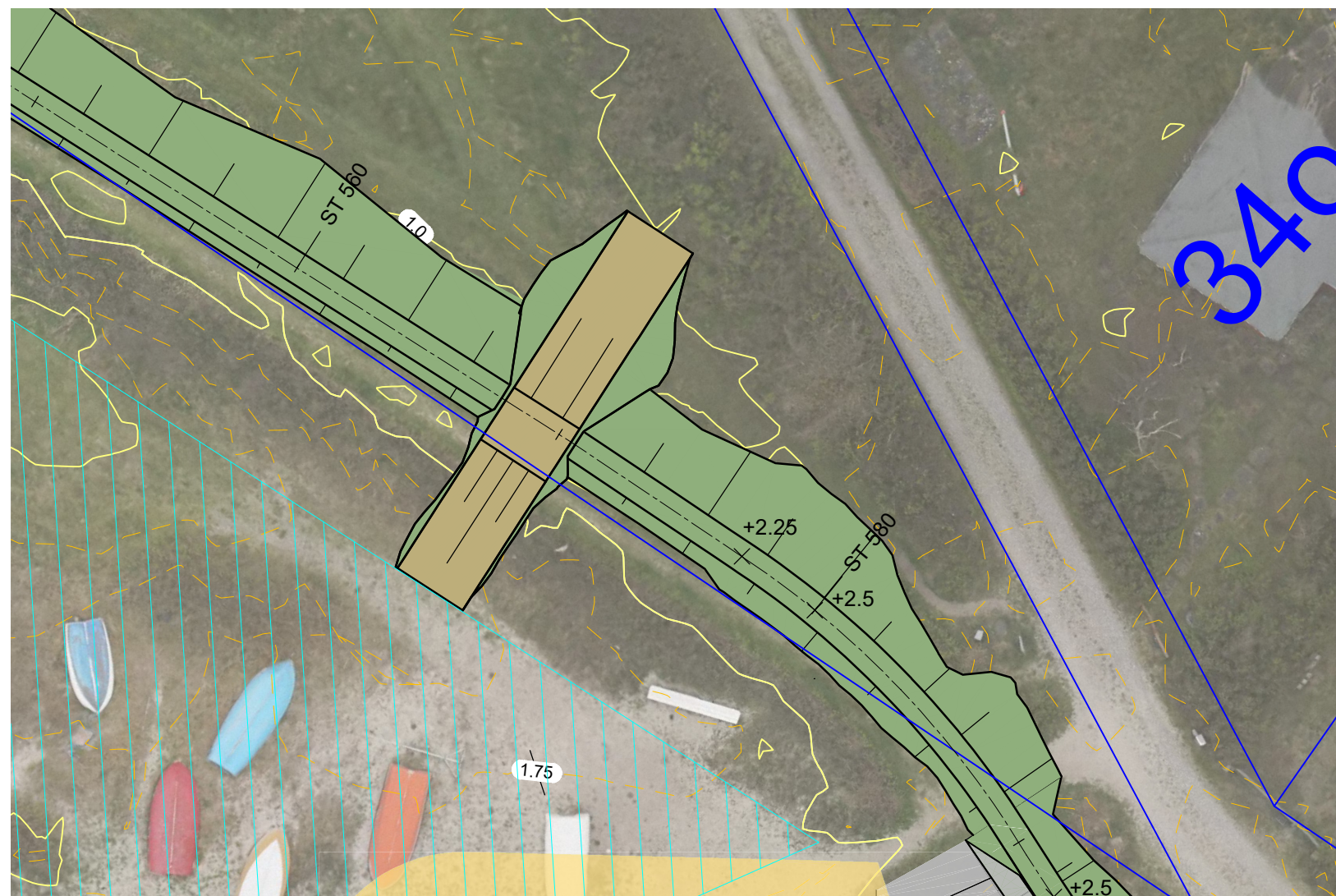
PLAN, 1:200 Overgang over dige. Bredde 2,5m. Anlæg 1:5
