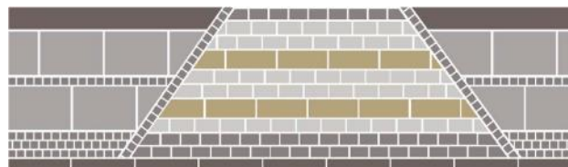
Figur 4: Brostensoverkørsel med gangbane i bordursten og savede og jetbrændte brosten
