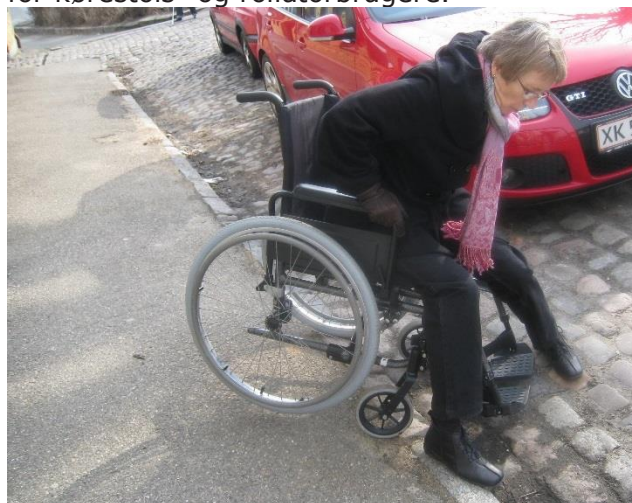
Foto 50: Kørestolsbruger, der er kørt af gangbane pga. for stejlt tværfald.
