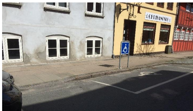
Foto 64: Korrekt udformet handicapparkering. Nedsænket rampe gør det muligt for kørestolsbrugere at komme fra pladsen til fortovet.
