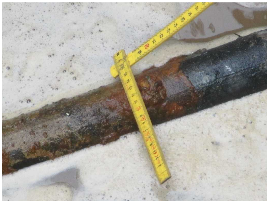
Figur 3.5: Dimension af ankerstang ved campingpladsen.
