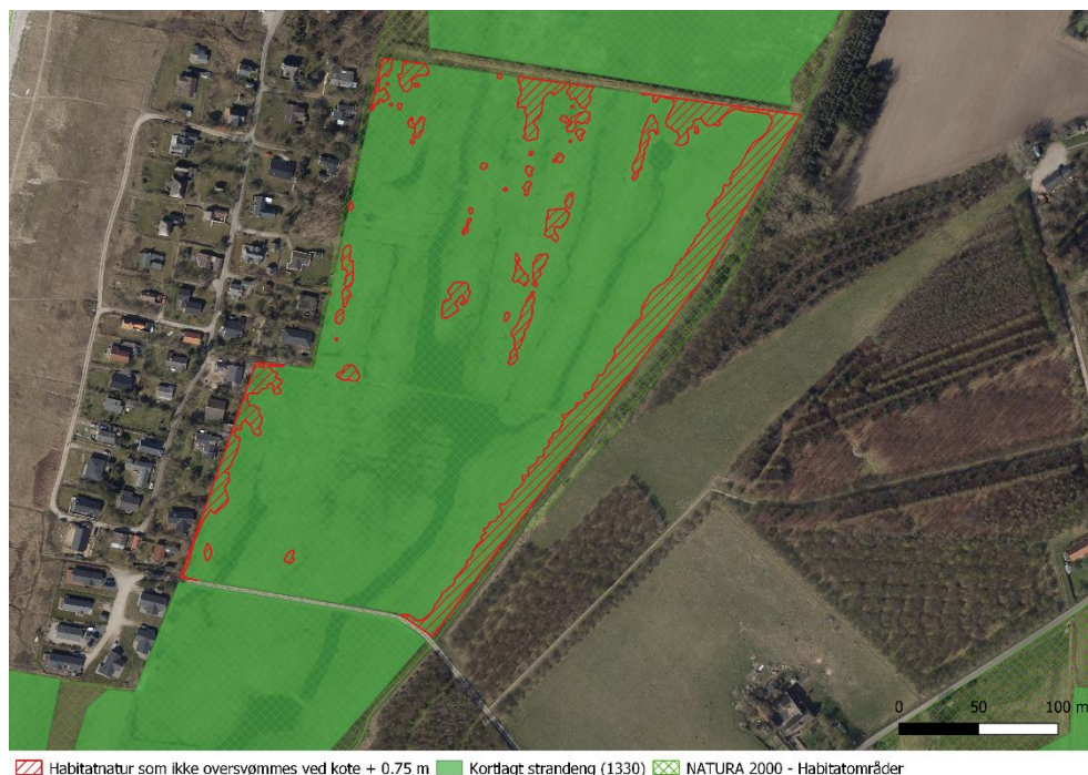
Figur 10-2 Arealer på den nordlige side af højvandssikringen for løsningsforslag 1-3, som ligger over kote +0.75 m DVR90 ifølge den dansk højdemodel (rød skravering). Det grønne areal angiver, hvor der er kortlagt strandeng (1330) og den grønne skravering afgrænsningen af Natura 2000-området.
