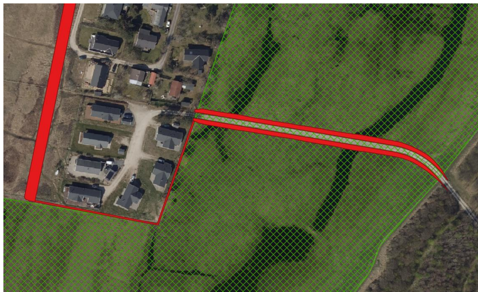
Figur 4-7 Den røde markering angiver den estimerede permanente arealinddragelse ved hævnning af den eksisterende vej (Strækning 1), spunsvæggen (Strækning 2-3) og den sydlige del af kystdiget (Strækning 4) for løsningsforslag 1. Figuren viser udbredelsen af Natura 2000-område N162 omkring Kobæk Sønderstand (grøn skravering), og der er kun overlap mellem løsningsforslag 1 og N2000 ved den eksisterende vej.
