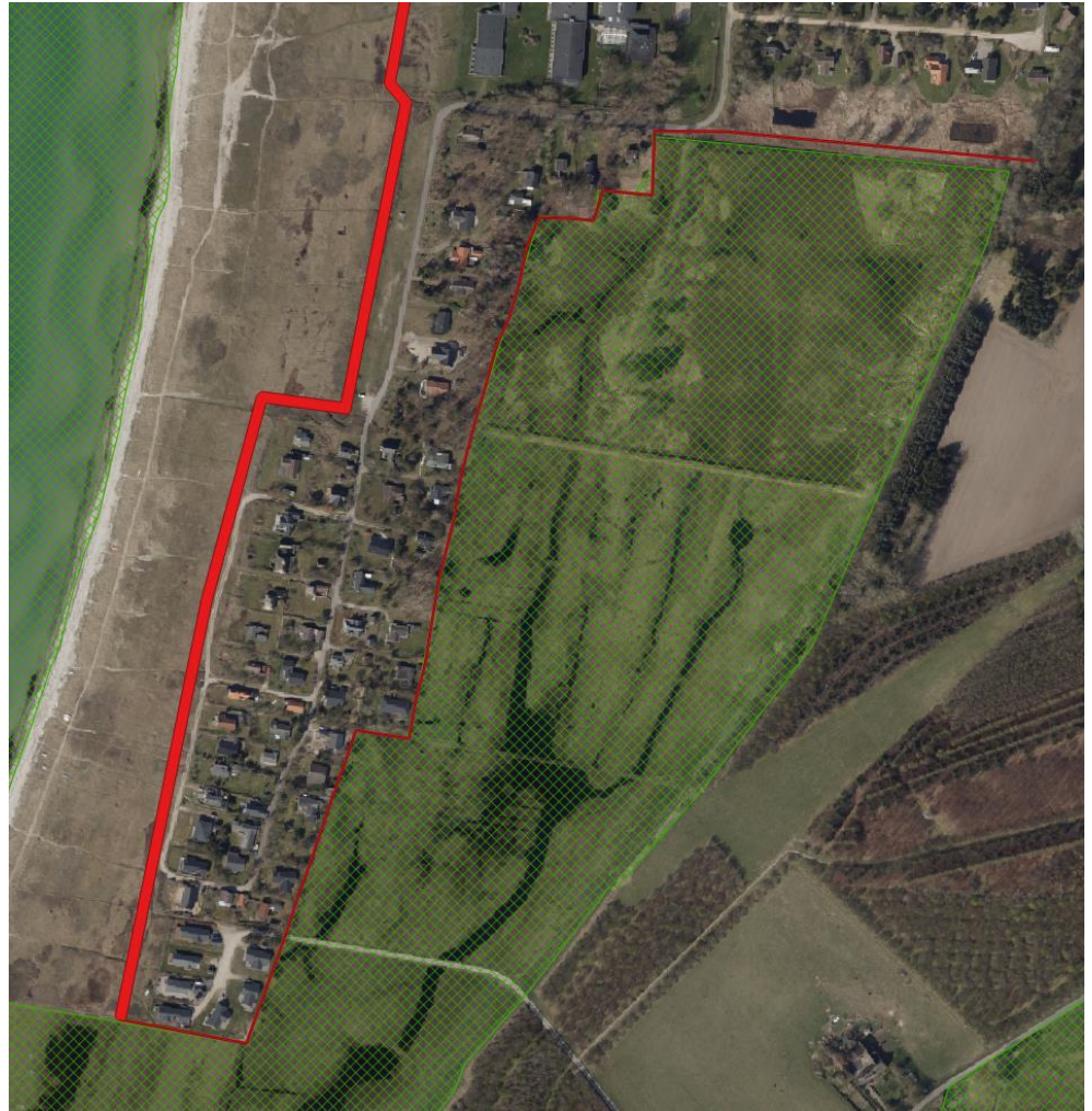
Figur 4-14 Den røde markering angiver den estimerede permanente arealinddragelse hvis der etableres spuns langs hele østsiden af sommerhusområdet, samt for spunsvæggen (Strækning 2-3) og den sydlige del af kystdiget (Strækning 4) for løsningsforslag 4. Figuren viser udbredelsen af Natura 2000-område N162 omkring Kobæk Sønderstrand (grøn skravering).
