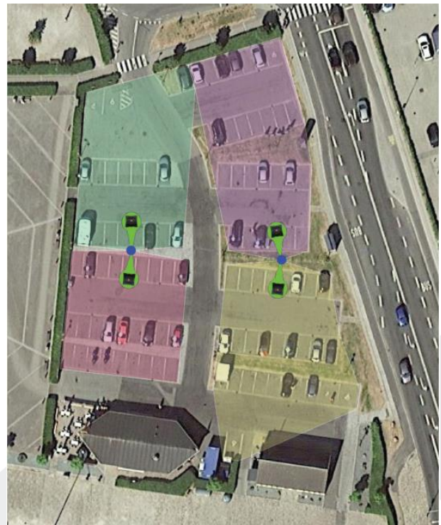
Figur 2: Eksempel på detailprojektering af antal sensorer til p-område
