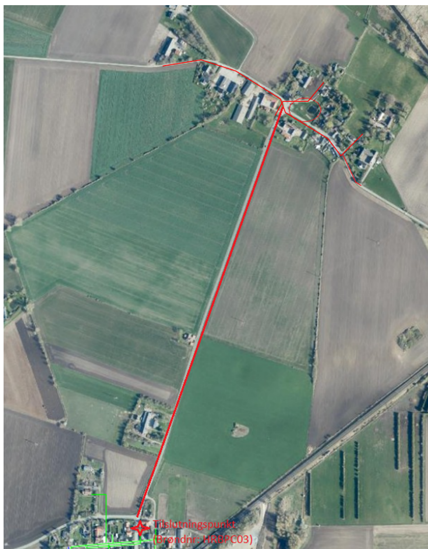
Figur 2: Planlagt placering af ledninger, inklusiv trykleddning fra Gammel Forlev til Forlev med tilhørende tilslutningspunkt og trykpumpestation. Den røde cirkel i Gammel Forlev indikerer den forventede placering af pumpestationen.
