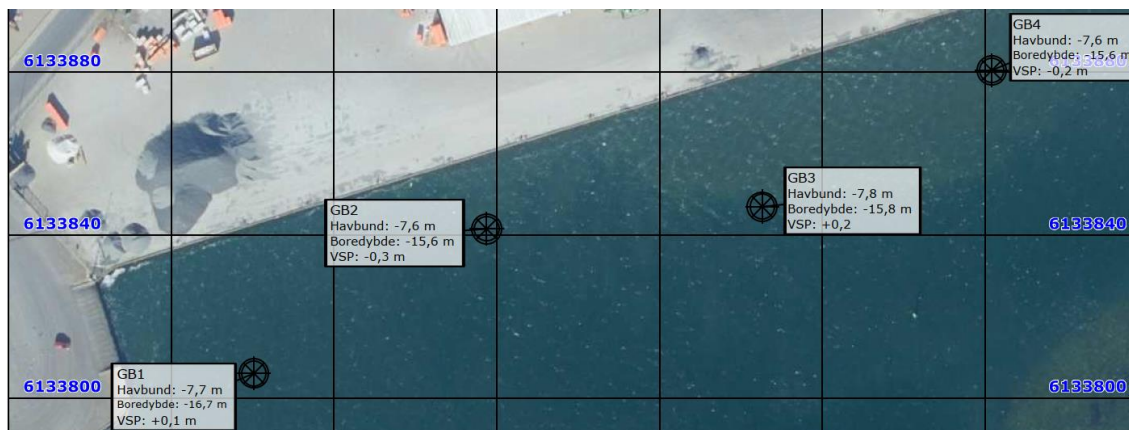
Figur 5: Placering af de udførte geotekniske bundundersøgelser.
