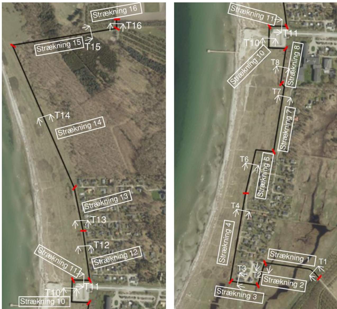
Figur B-1 Oversigt over strækninger og tilhørende tværsnit af diget langs linjeføringen. Til venstre ses den nordlige del af linjeføringen. T1 er ensbetydende med Tværsnit 1, T2 er ensbetydende med tværsnit 2, osv. Strækning 5 og 9 udgår, da disse er sammenfaldende med tværsnittene brugt langs henholdsvis strækning 6 og 10.
