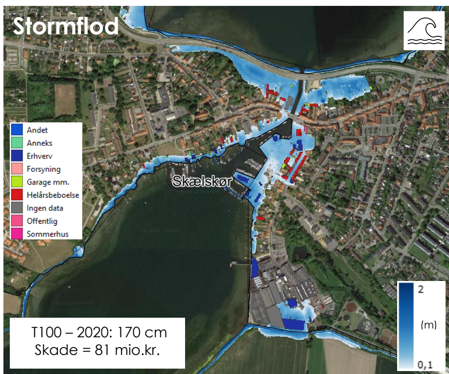
Figur A2-2. Skadesberegninger stormflod – bygningskategorier, Skælskør
