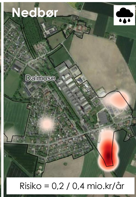
FIGUR 2-13: RISIKOKORT FOR OVERSVØMMELSER FRA NEDBØR FOR UDVALGTE BYER I SLAGELSE KOMMUNE PRÆSENTERET SOM HEAT MAP, HVOR RISIKOFYLDTE HOTSPOTS UDPEGES (RØD = HØJ RISIKO). RISIKOEN ER BEREGNET FOR T20, T50 OG T100 (LAV VÆRDI) OG FOR T5, T10, T20, T50 OG T100 (HØJ VÆRDI).
