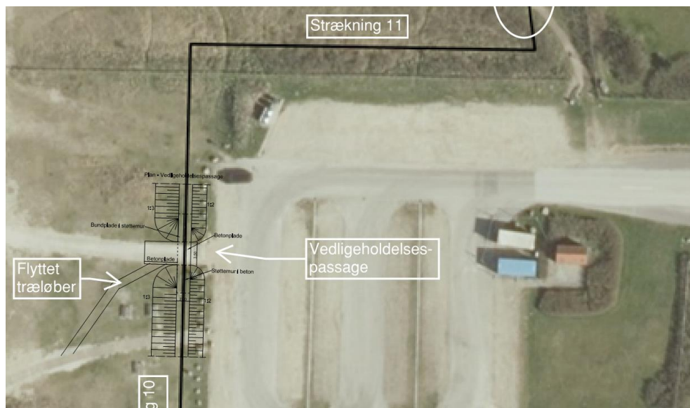
Figur 9-2 Illustration af princippet for vedligeholdelsespassagen ved parkeringspladsen.
