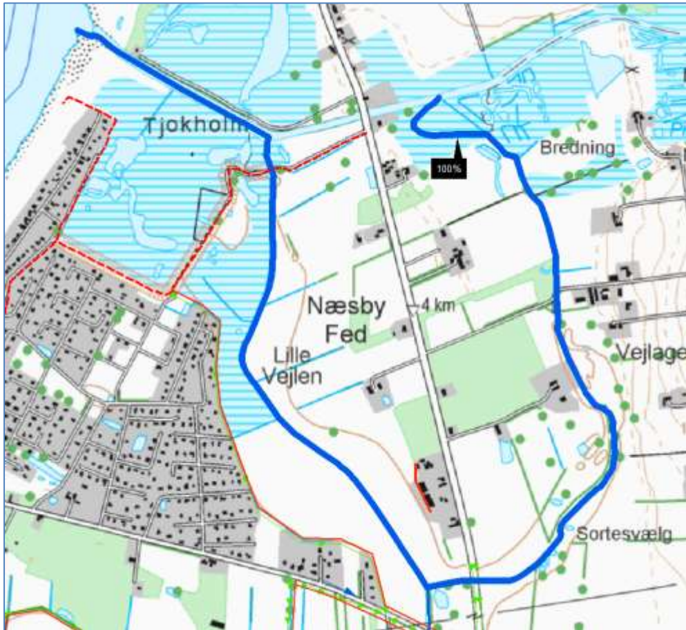
Figur 2: Det eksisterende projekt. Her ledes alt vand gennem Vejlerne, og der etableres således kun et højvandslukke i Tjokholmdæmningen.
