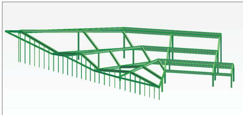
3D RENDERING AF DE BÆRENDE STÅLKONSTRUKTIONER
