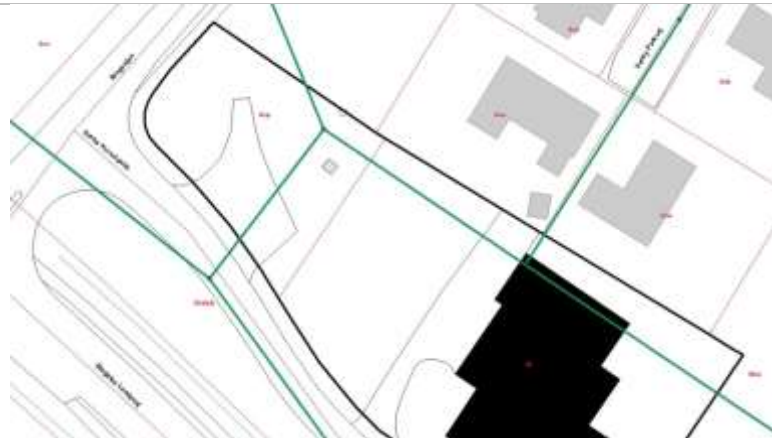
Placering af eksisterende spildevandsledning til fælleskloakering.
