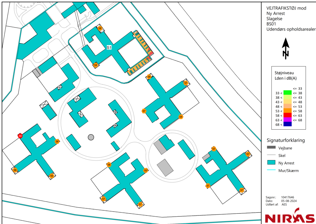
Figur 5.42: Støjkort over punktregninger og støjkonturlinjer – opholdsarealer i det uskærmede 2040-scenarie
