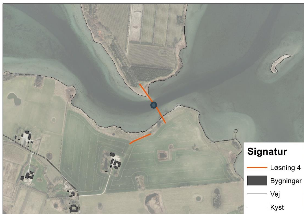
Figur 1-4 Principskitse for Løsning 4. Løsningen har få landbaserede sikringstiltag, men indeholder etableringen af en sluse/højvandsport i sejlrenden (markeret med prik).
