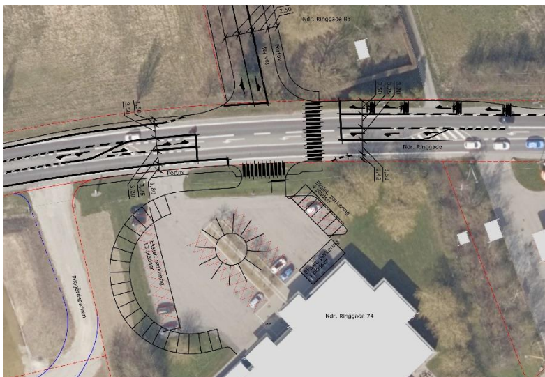
Illustrationen viser et eksempel på et lyskryds samt diverse tilpasninger som fortov, fodgængerfelt mv.
