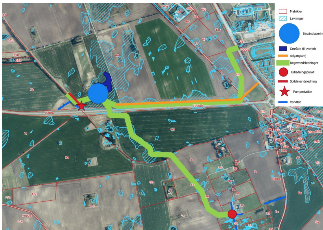
Figur 2: Oversigt over bassinets placering (blå). Udledningspunktet, på Harrested Å har en rød cirkel. Ledningstracérerne er angivet med grøn. Adgangsvejen ses med orange. Rød stjerne markerer pumpestation til spildevandet fra Arresten.
