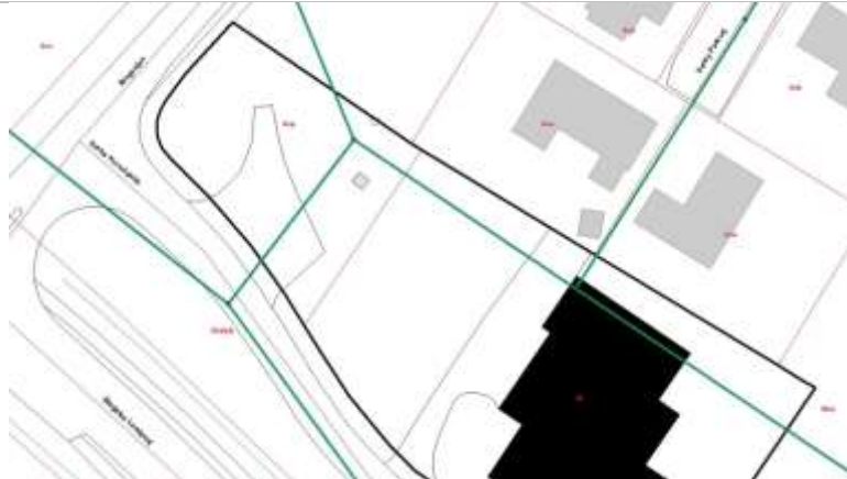
Placering af eksisterende spildevandsledning til fælleskloakering.
