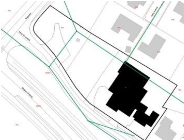
Placering af Kloakledning.
