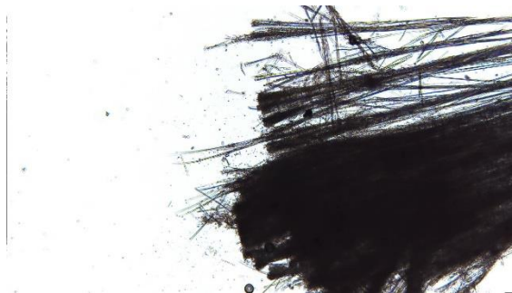
#2 Asbestfiber i P11 (100x forstørrelse).
