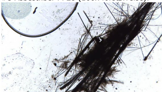
#7 Asbestfiber i P58 (100x forstørrelse).
