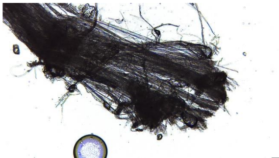
#1 Asbestfiber i P5 (100x forstørrelse).
