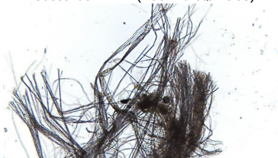
#6 Asbestfiber i P53 (100x forstørrelse).
