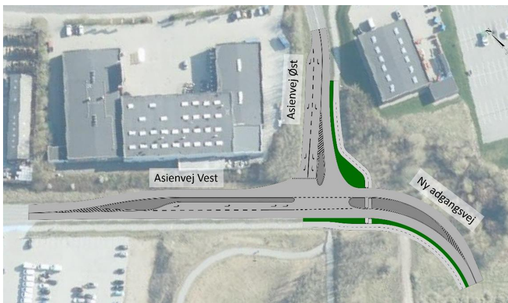
Figur 11. Principskitse af et vigepligtsreguleret kryds i krydset mellem Asienvej Vest, Asienvej Øst og adgangsvejen til det nye butiksområde. Krydset kan afvikle den forventede trafik ved en 65 % udbygning af butiksområdet.
