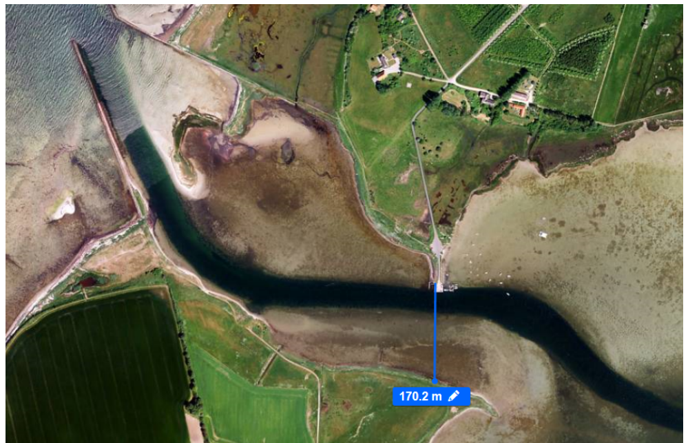
Figur 4-3 Mulig placering af højvandslukke ved Lodsbroen
