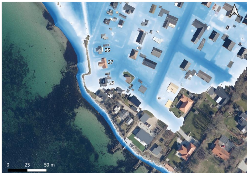
Figur 3: Oversvømmelse ved dimensionsgivende vandstand på +2,06 m DVR90.
