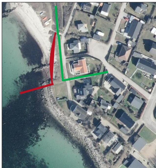
Figur 2: Alternativt løsningsforslag med forkortet skråningsbeskyttelse og en mole, samt forlængelse af dige landværts.
