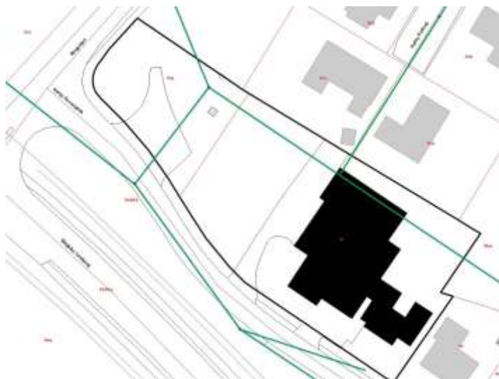
Placering af Kloakledning.
