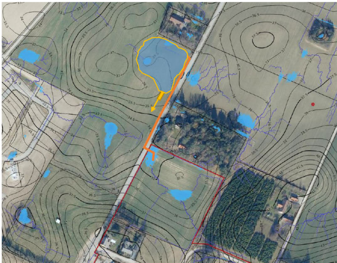
Figur 5-7 Foreslået placering af fælles regnvandssø udformet som vådbassin for hele lokalplanområdet - vist i sin maksimale udstrækning nedstrøms lokalplanområdet. Tilløb fra lokalplanområdet kan ske langs Rosenkildevejs vestlige side i gravitationsrør. Et eventuelt Rockflow-filter på bassinafløbet (vist med gult rektangel) bør placeres ved udløbet nær Rosenkildevej (vist med orange streg) aht. driftsadgang. Afløb fra søen føres droslet mod syd til hoveddrænet, der afleder det rensede vand videre mod vest til Gudum Å.
