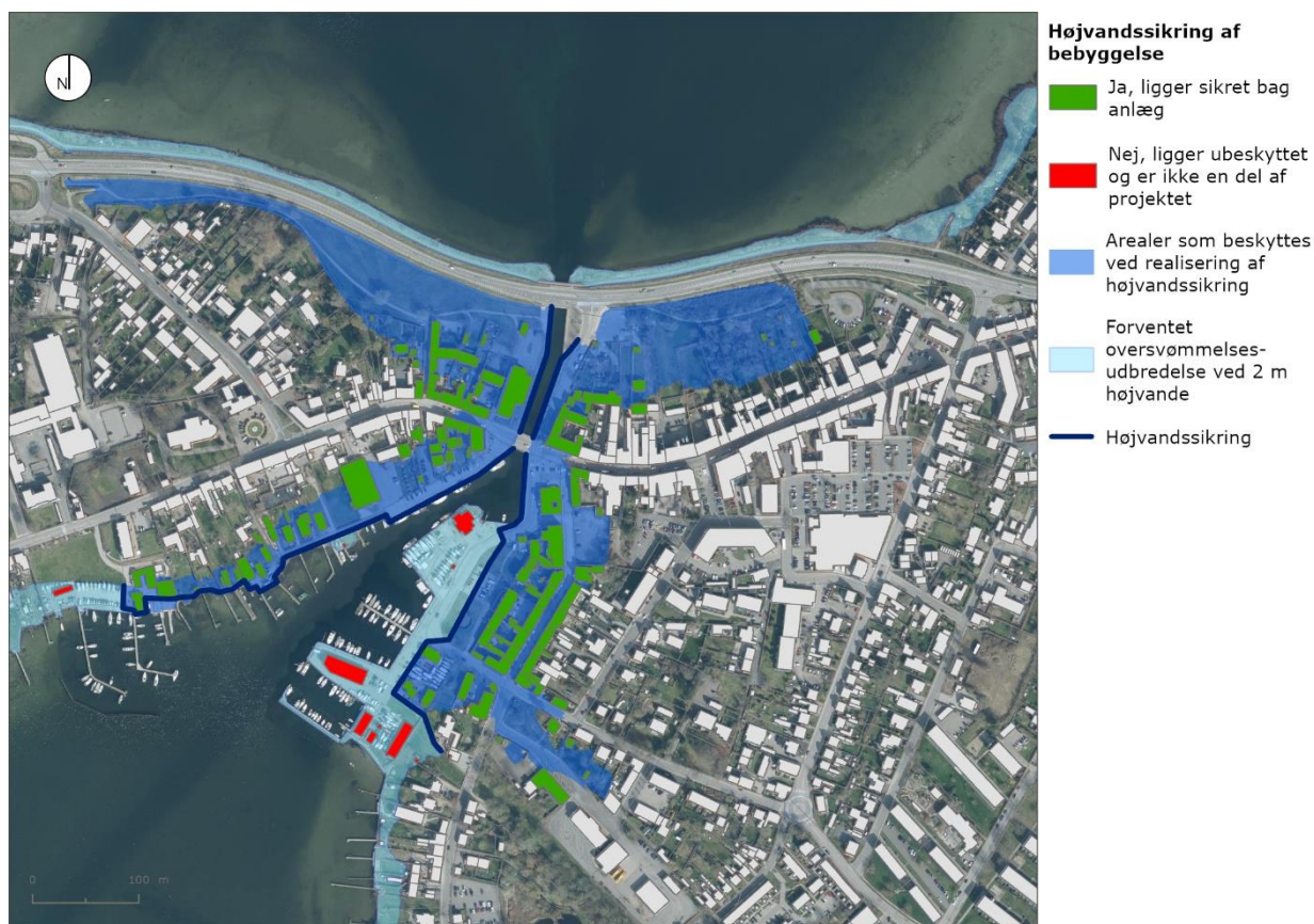
Figur 4: Kort over Skælskør med linjeføring for den planlagte højvandssikring og markering af, hvilke bebyggelser som sikres, ref. (19).
