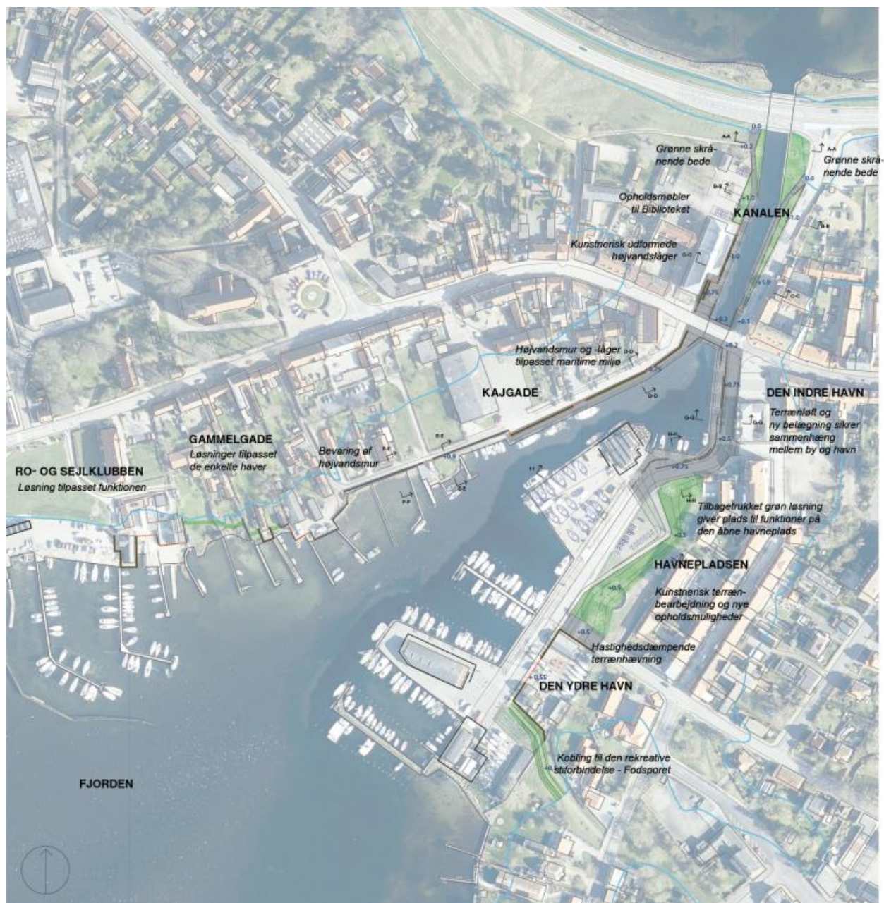
Figur 3: Illustration af de skitserede greb og designprincipper for højvandssikring, ref. (19).
