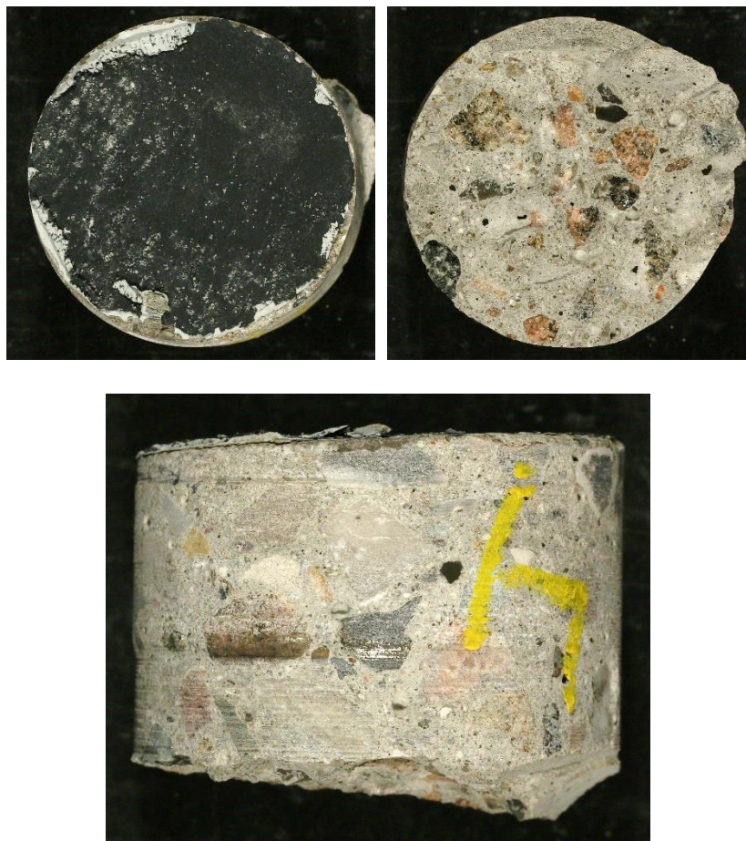
Figur 13-4: Fotos af prøve 4. Øverst ses til venstre foto af kerneoverflade (boreside) og til venstre bagsiden. Billedet herunder viser kernen som udboret med overfladen vendt opefter. Kernens diameter er 49 mm.
