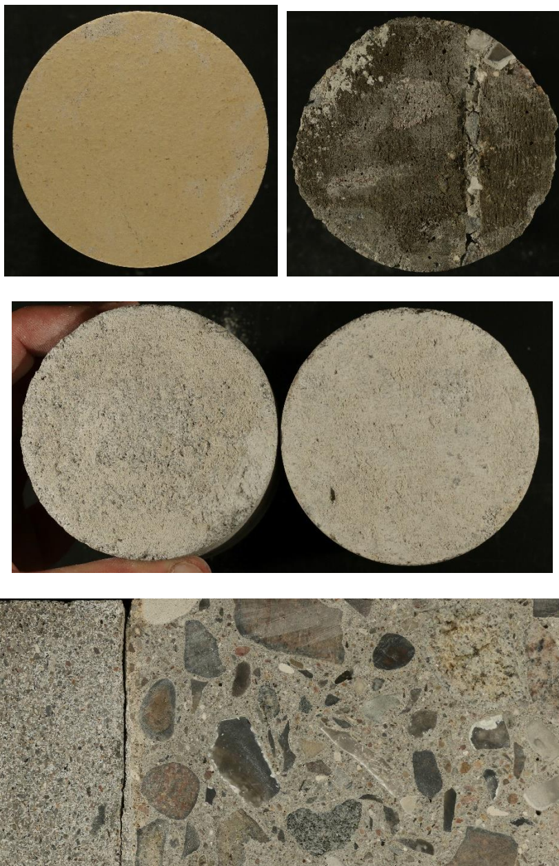
Figur 13-2: Fotos af prøve 2. Øverst ses til venstre foto af kerneoverflade (overside) og til venstre undersiden. Billedet i midten viser revneflader til brud gennem pudslag. Nederste billede herunder viser aksiale plansnit gennem den borekerne med oversiden mod venstre. Kernens diameter er 79 mm.
