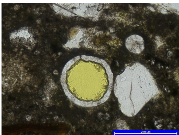
Figur 14-26: Massive udfældninger af ettringit i luftpore. Planpolariseret lys
