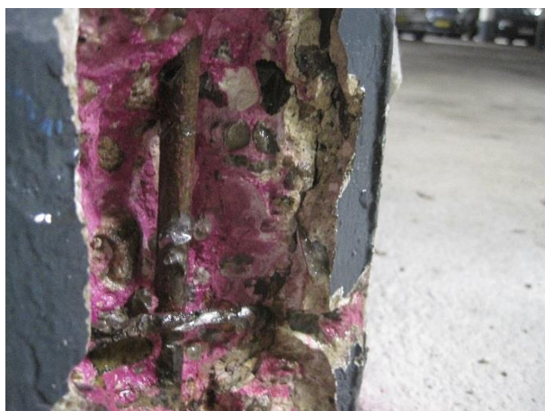
5. Behugning af søjle nr. 67: Bestemmelse af carboniseringsfronten.
