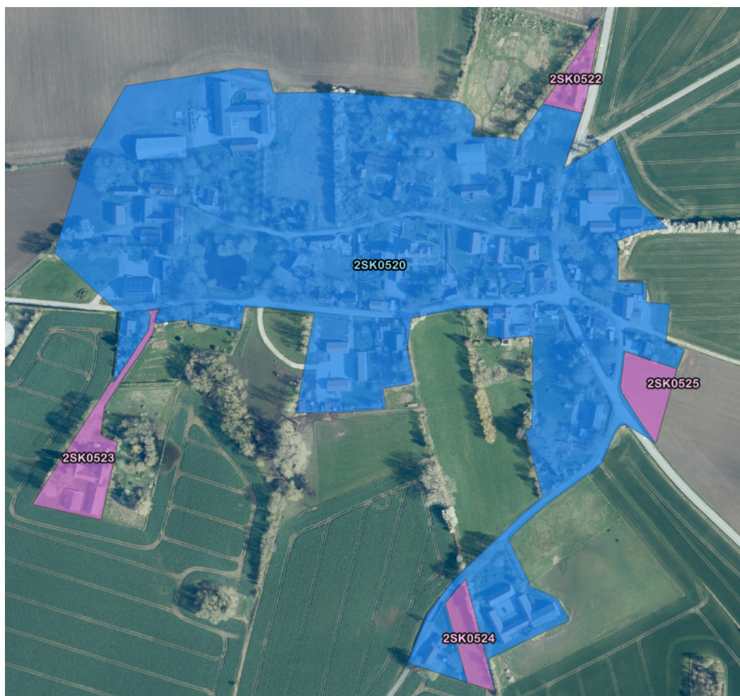
Figur 2: Planlagte kloakoplande for Skørpinge. Mørkeblå er separatkloakeret opland og magenta er spildevandskloakeret opland.
