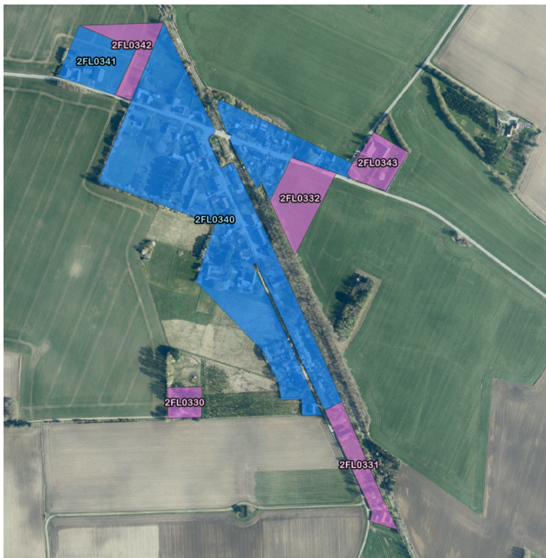
Figur 3: Planlagte kloakoplande for Flakkebjerg Stationsby. Mørkeblå er separatkloakeret opland og magenta er spildevandskloakeret opland.
