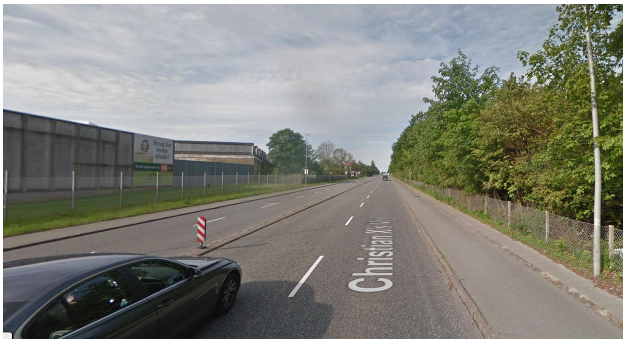
Figur 4: Eksempel på fysisk adskillelse mellem kørebaner, der umuliggør overhaling i yderste spor.
